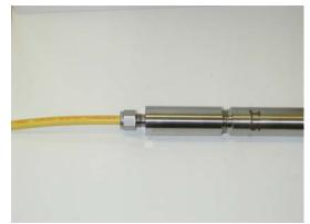
7) Tighten cable seal.
